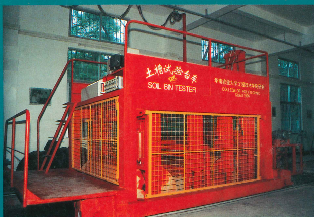
华南农业大学工程技术学院研制的土槽试验台车在土壤机器系统力学重点实验室
